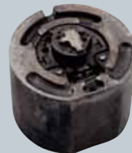
Verschmutztes Zink-Druckguss- werkzeug mit Entformungsproblemen
