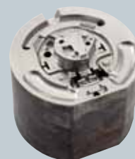
Gereinigtes Werkzeug mit gelöstem Entformungsproblem
